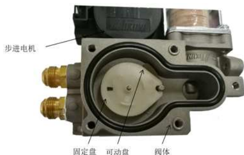
图 1 本次研究的电控燃气流量控制阀结构
