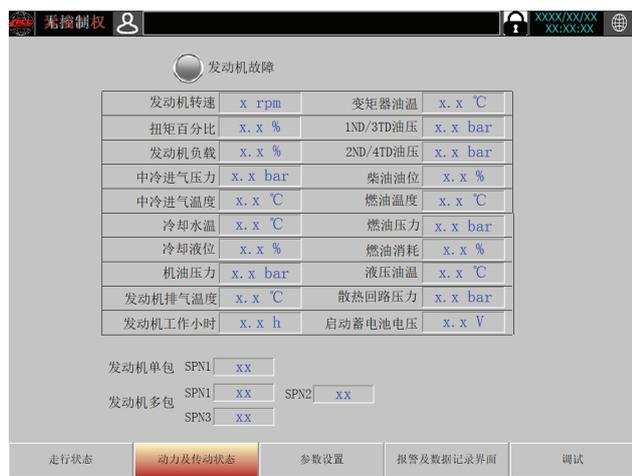
(二) 操作台：前后司机室内各设置一个司机操纵台，便于操纵机车-车辆的正反向行驶。操纵台上布置有机车状态显示屏、机车方向/速度控制手柄、制动阀、紧急制动按钮、制动及缓解按钮，以及保证机车正常运行的各种监视仪表、指示灯和开关按钮。为保证运行安全，司机室操纵台上设置机车各种故障监测、报警和自动保护功能的装置，实施机车监视、警告、卸载和停机的自动保护。操作台布局图如下：
