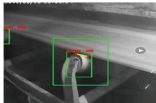
图c 皮带跑偏检测
