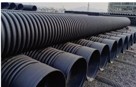
图1 高密度聚乙烯(HDPE)管材
