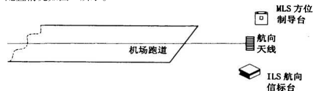
图 2 仪表着陆和微波着陆设备的机场配置
