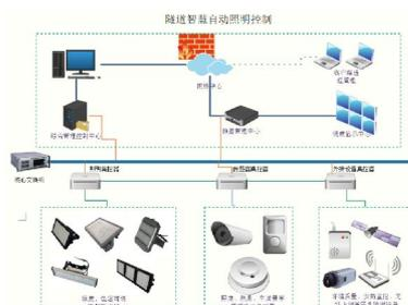
图 1 系统网络拓扑结构
