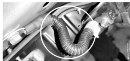
图1 过长接地线装配效果
