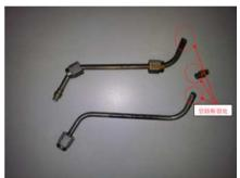
引气系统的信号管路是硬管,且长度较短,当安装方法不当时,容易造成残存应力,并且这些管路都处于高振动区域,容易造成疲劳断裂。在排故时,要对信号管路加强检查,不光要看管路状态是否好,还要用手轻晃管路,并在管路/活门供气时检查管路是否断裂和是否存在渗漏情况。在安装信号管路时,要将管路两端用手带紧后在按照手册磅紧。
