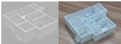
图1 BIM+3D打印技术辅助验证分析标准化户型合理性
