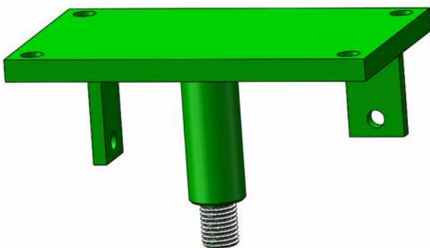
图6 改进后的挡块旋转支座
