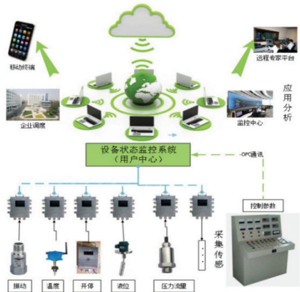
图2 煤矿机电设备智能化诊断系统
