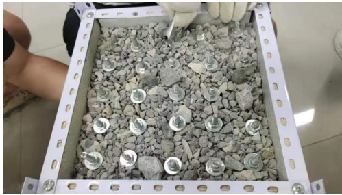
图1 锚固试件加工流程
