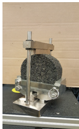
图2 理想剪切车辙试验装置 [10]
