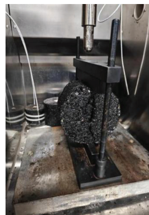
图 1 间接拉伸试验装置
