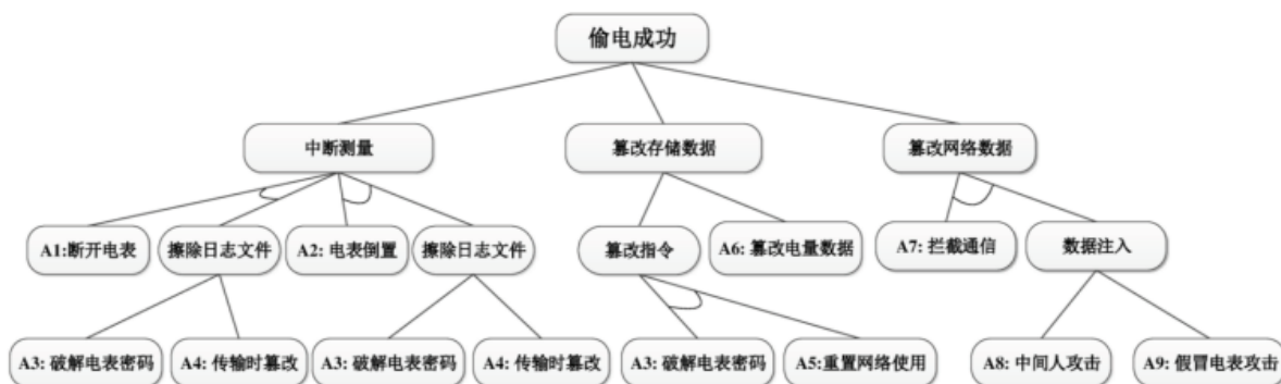
图3 高级测量体系偷电攻击树模型图
