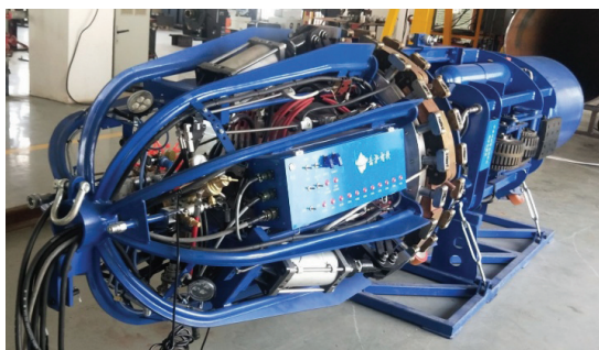
图1 管道自动焊接机
