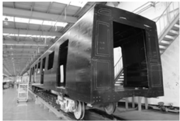
图11 长客股份公司研制的地铁车辆车体
