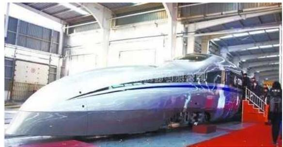
图12 中车青岛四方的500km/h高速试验车
