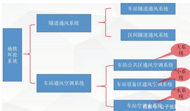
图1 地铁环控系统构成
