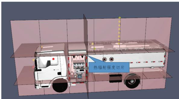
图3-5 油罐火灾测量装置设置
