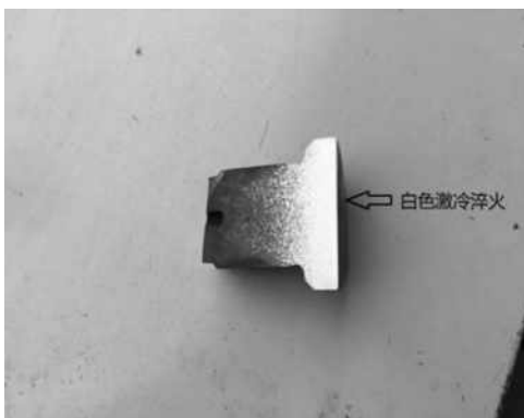
图2 裂纹在激冷层
