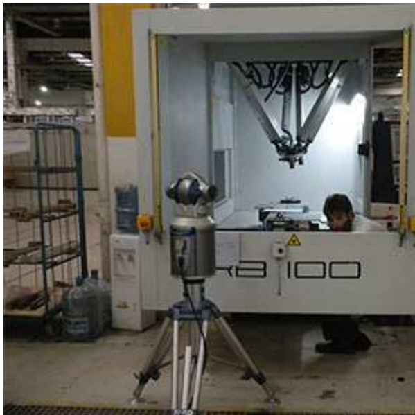
图1 激光跟踪仪测量误差图
