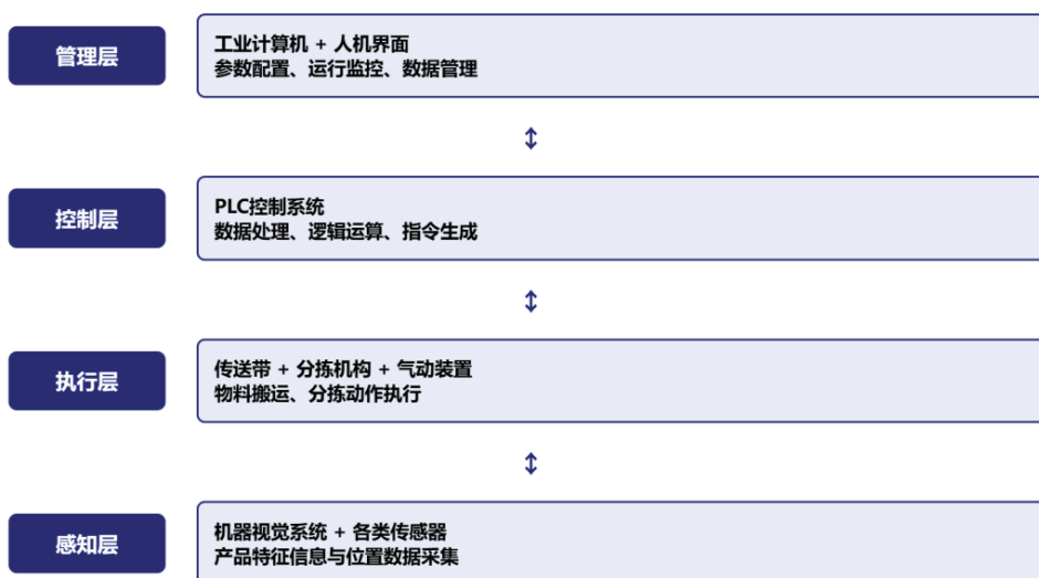
图1 分拣控制系统层级架构
