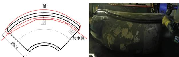
图4 偏心导体法检测多匝布置
