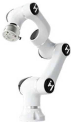
图1 E03-Pro协作机器人
