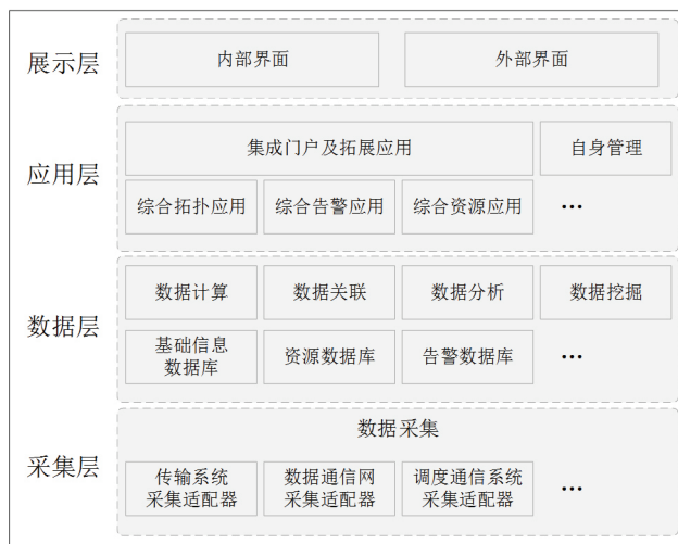
图1 综合网络管理系统软件架构图
