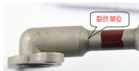
图2 故障件裂纹部位图
