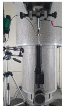
图13 减振器振动台架
