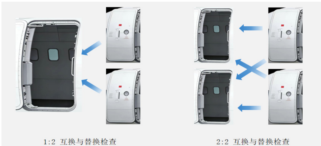
图1 互换与替换检查示意图
