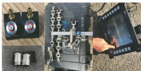
(a) 充水模块及探头 (b) 扫描架及编码器 (c) TOFD主机
