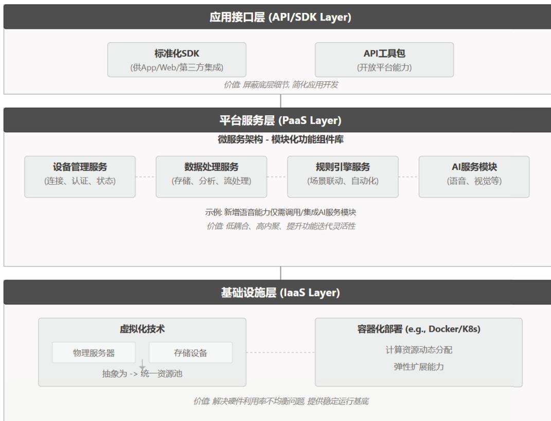
动态分配与弹性扩展。资源管理模式有效解决了传统架构中硬件利用率不均衡的问题，为上层应用提供稳定的运行基底。平台服务层采用微服务架构构建模块化功能组件库，将设备管理、数据处理、规则引擎等核心功能拆分为独立服务单元，既降低了系统耦合度，又提升了功能迭代的灵活性<sup>[5]</sup>。例如，当需要新增语音识别能力时，可凭借调用预置的AI服务模块快速完成集成。应用接口层则通过标准化SDK与API工具包对外输出能力，开发者无需关注底层技术细节即可快速构建定制化应用。
