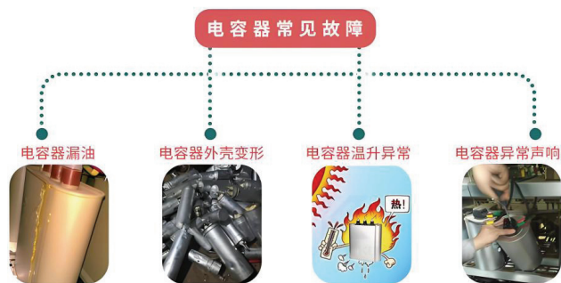
图1 电容器常见故障示意图
